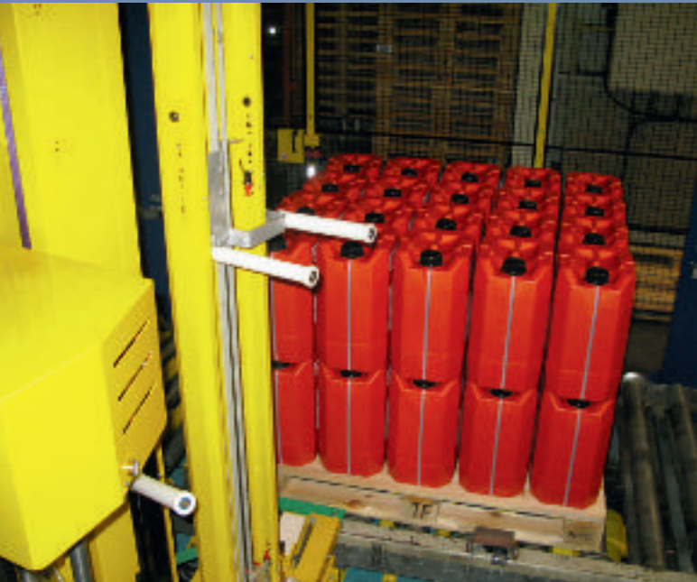
De Tendomatic is voorzien van een tweede as voor het vormen van de rope.
