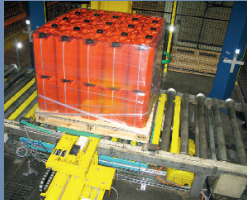
Drie kruiselingse 'rope-wikkelingen' reiken tot een ladinghoogte van circa 30 cm boven de pallet.
